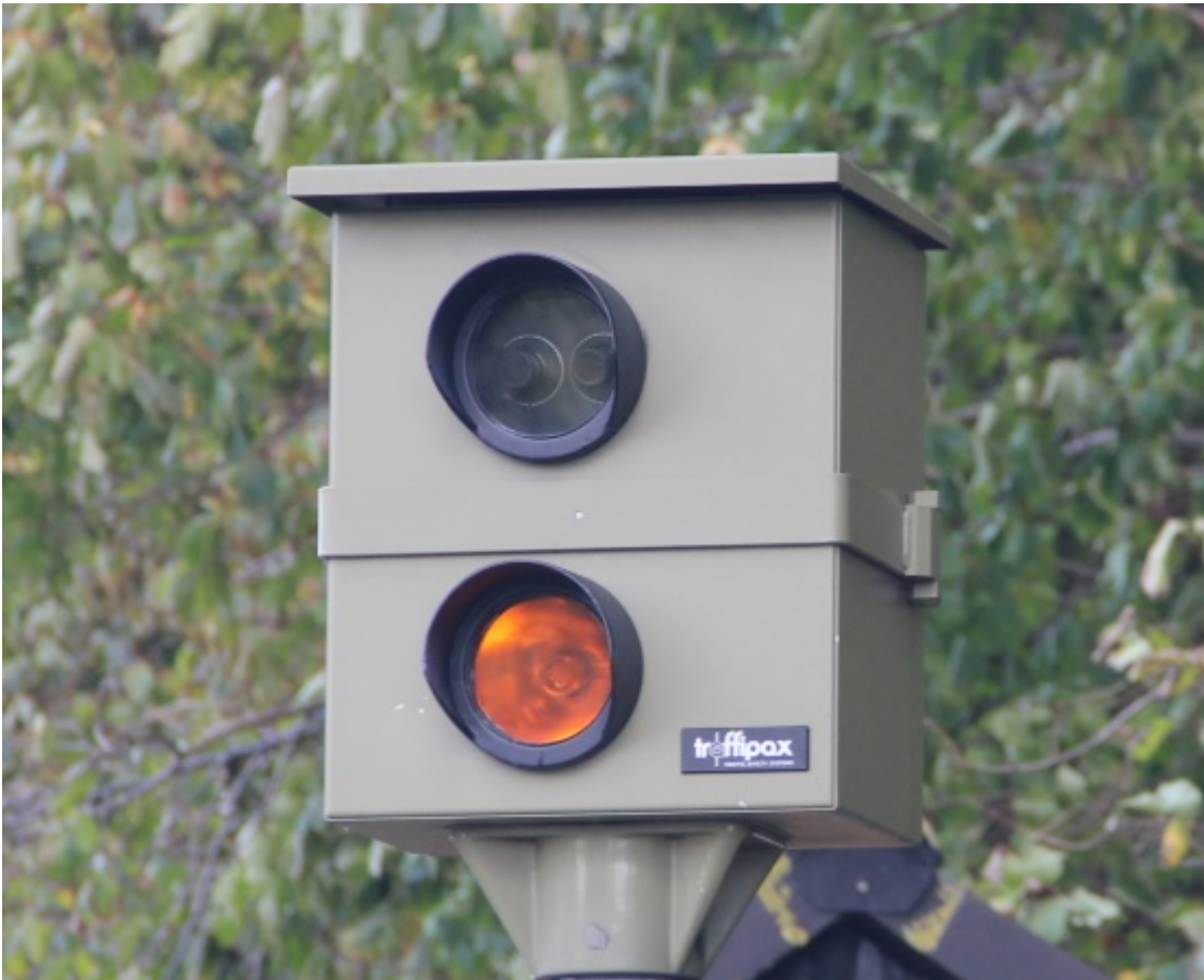
Abbildung 4: Gleiche Messstelle wie zuvor, bestückt mit SmartCamera IV
