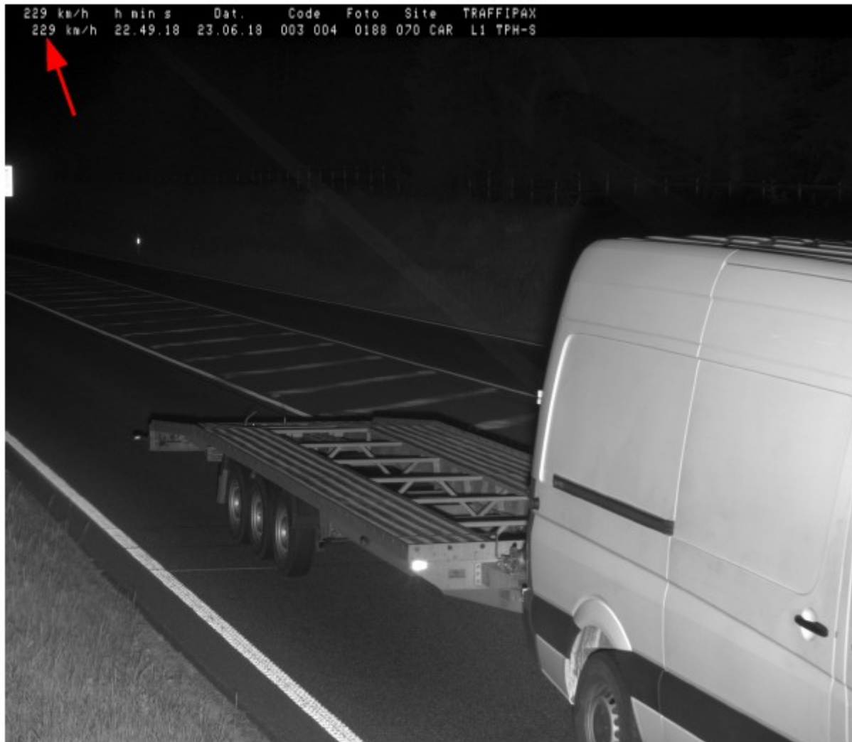
Abbildung 12: Messfoto (Bild 0188) mit offensichtlich falschem Messwert
